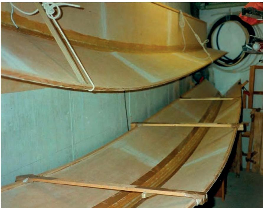
Als nächster Schritt werden der nun offene Rumpf umgedreht und die Kupferdrähte abgezwickelt, die Kiellinie wieder glatt verschliffen und von außen auch mit 3 Gewebebändern laminiert.
