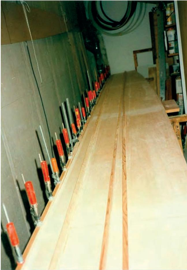
Dann erfolgt die Näharbeit. Im Abstand von 5mm von der Unterkante werden alle 10cm Löcher mit 2mm Durchmesser gebohrt. Anschließend mit Kupferdraht je zwei Seitenteile verbunden. Die Seitenteile aufklappen und die Kielwinkel für alle Positionen einstellen, dann wird die Kiellinie von innen mit 3 Glasgewebe-Streifen überlappend fixiert.
