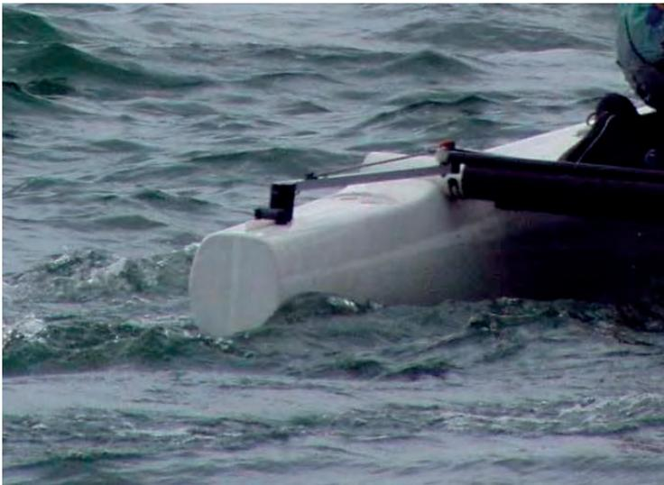
Das Ruderblatt sitzt unter dem Heck mit ganz geringem Abstand zum Rumpf. Das ist strömungstechnisch günstig, weil Verwirbelungen nahezu unterbunden werden. Das Ruderblatt wird durch einen Schacht im Heck des Rumpfes nach unten geschoben. Der Schacht wie auch der Ruderkopf haben ungefähr die gleiche Querschnittsform wie das Ruderblatt. Der Ruderkopf, in dem die Ruderachse gelagert ist, füllt bei abgesenktem Ruder den Schacht vollständig aus. Die Rumpfoberfläche ist somit möglichst
